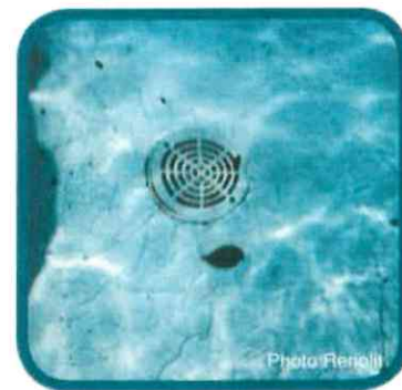
Décoloration violente de la membrane, au voisinage de la bonde de fond, due à un fort excès de chlore. L'oxydation des pigments s'est également accompagnée de la formation de ridules.
